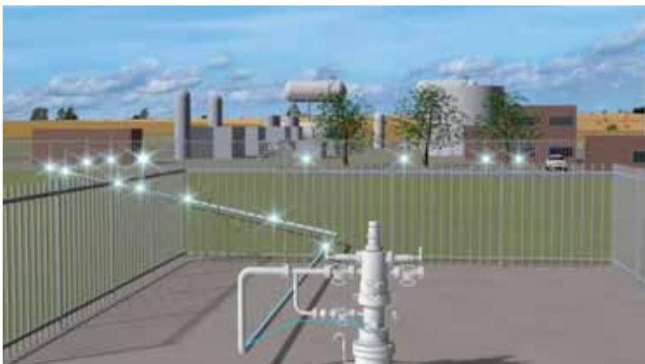
Gedetailleerde informatie van over de gehele lengte van de kabel wordt via kabel en satelliet naar wereldwijde Shell Process Optimization Centres gestuurd, waar specialisten de real time informatie uit putten en reservoirs interpreteren.
